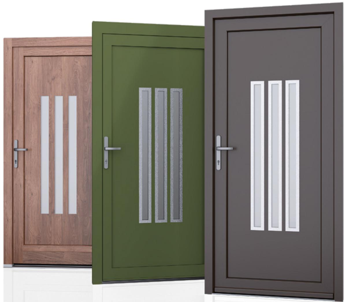
Nous proposons à nos clients des panneaux avec deux types d'âme isolante : en mousse polyuréthane et contreplaqué ou en polystyrène extrudé XPS, dont chacun peut avoir une épaisseur de 24, 36 et 48 mm. Les panneaux, en fonction des préférences du client et des exigences techniques, sont fabriqués en HPL ou en tôle d'aluminium. Les panneaux HPL sont plaxés et l'aluminium est laqué. Pour les portes en bois, nous proposons les panneaux de l'épaisseurs de 24, 36 et 46 mm.
